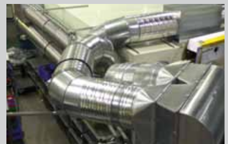
Inneres des MAXYMUS. Von links tritt der Strahl ein und wird mit einem Detektorsystem (rechts) gemessen.
